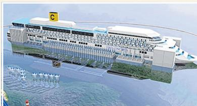
**Nächste Schritte:** In den kommenden Monaten werden Auftriebskörper an der beschädigten Schiffseite montiert. Damit soll der Auftrieb für den Abtransport erzeugt werden.
