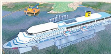
**Kippen:** Über Stahlseile und 48 Litzenheber wurde das Schiff mit einer Zugkraft von 5000 t bis 6000 t in Bewegung gebracht. Geflutete Auftriebskörper vollendeten den Kippvorgang.
